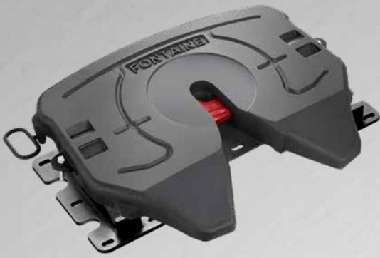
Fontaine ofrece ahora la alternativa a la QR Holland FW35 y FW70 – La Quinta Rueda serie H7 con el montaje estacionario FMAH, esta QR tiene un patrón de montaje de 5 tornillos que permite un rápido y sencillo cambio
